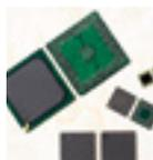
シリコンチップを樹脂で封止してゴミや水分から保護し、放熱性や実装性を向上させます。
